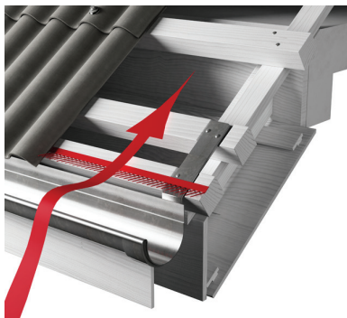
Joonis 5. Katuseräästas: tuulutusavade pindala 1 jooksva meetri kohta: plaadid W130-9 – 120 cm 2 .
