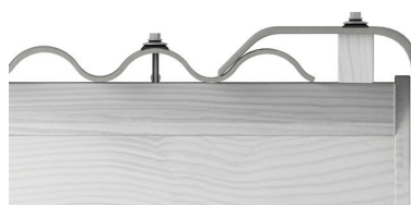
Joonis 40. Painutatud servaga tuulelaua paigaldamine.
